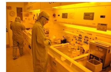
Sistemas de fotolitografía que fabrican circuitos integrados
